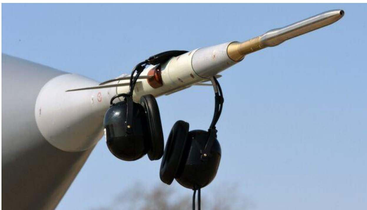
Рисунок 1. Приемник воздушного давления (ПВД) на МиГ 29
